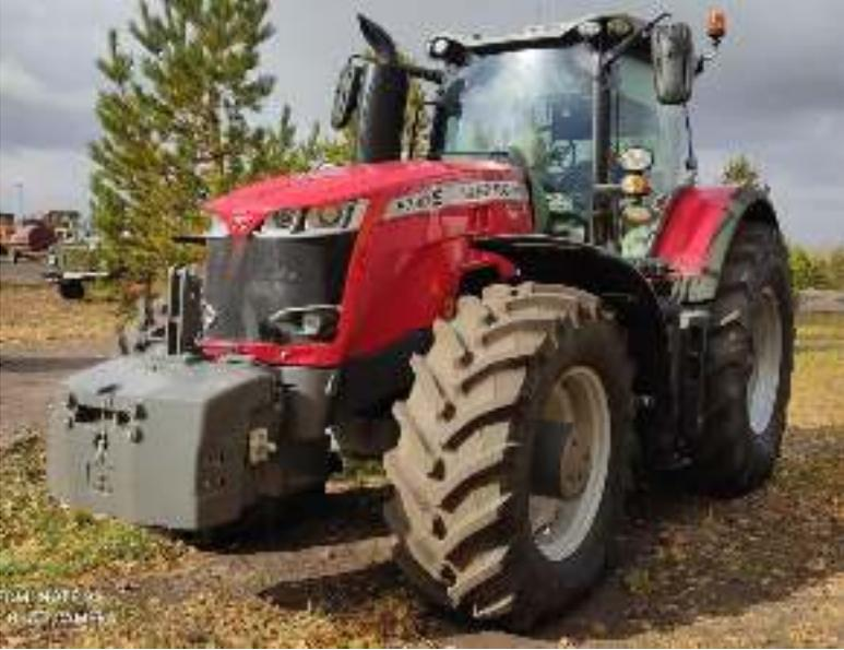
A red Massey Ferguson 8730 tractor with large, treaded tires, parked outdoors on a dirt surface. The tractor is shown from a front-three-quarter view.                        | <p><b>Трактор колесный Massey Ferguson 8730.</b> Колёсный трактор 6 тягового класса (ТС 54 – 63 кН), максимальная мощность 6-ти цилиндрового двигателя 300 л.с. Объём 8.3 литра 4 (четыре) клапана на цилиндр. Крутящий момент 1400 Н-м. при 1500 об/мин. Топливная система Common Rail.</p>
